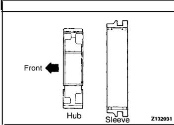
**►H◄ OD-R SYNCHRONIZER HUB/OD-R SYNCHRONIZER SLEEVE INSTALLATION**
