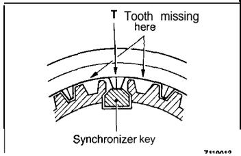
**►E◄ SYNCHRONIZER SPRING INSTALLATION**
