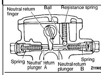
**►R◄ NEUTRAL RETURN PLUNGER (B) / NEUTRAL RETURN PLUNGER (A) / SPRING / SEAL PLUG / STEEL BALL / RESISTANCE SPRING INSTALLATION**
