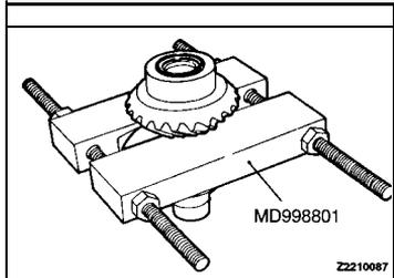
◀B▶ DRIVE BEVEL GEAR REMOVAL
