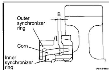
**REASSEMBLY SERVICE POINTS****▶A◀ SYNCHRONIZER SPRINGS INSTALLATION**
