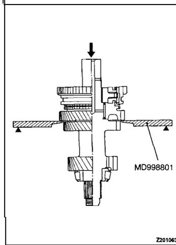
**◀B▶ 1ST-2ND SPEED SYNCHRONIZER HUB / 2ND SPEED GEAR REMOVAL**
