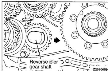
**►G◄ REVERSE IDLER GEAR SHAFT INSTALLATION**
