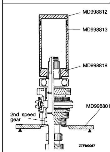
►G◄ REAR BALL BEARING INSTALLATION
