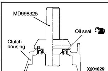
►I◄ OIL SEAL FOR DRIVE SHAFT INSTALLATION
