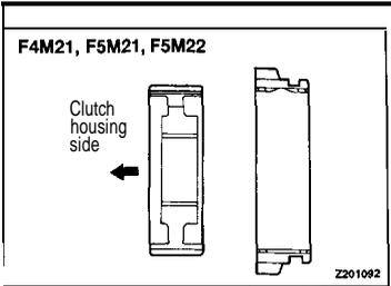
**►D◄ 1ST-2ND SPEED SYNCHRONIZER HUB | SYNCHRONIZER KEY | 1ST-2ND SYNCHRONIZER SLEEVE INSTALLATION**
