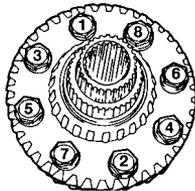
►D◄ TAPER ROLLER BEARINGS INSTALLATION
