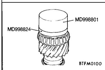
**▶B▶ TAPER ROLLER BEARINGS INSTALLATION**
