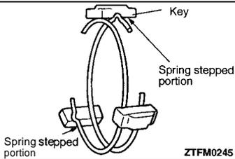
**▶B◀ SYNCHRONIZER SPRING I SYNCHRONIZER KEY INSTALLATION**
