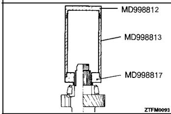
▶◀ **B** TAPER ROLLER BEARING INSTALLATION
