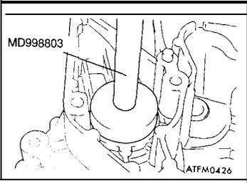
►F◄ DRIVE SHAFT OIL SEAL INSTALLATION
