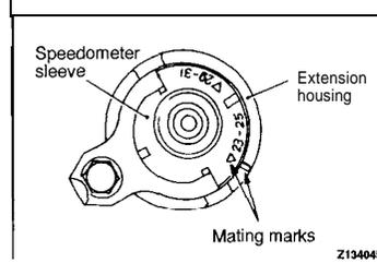
**►S◄ SPEEDOMETER GEAR INSTALLATION**
