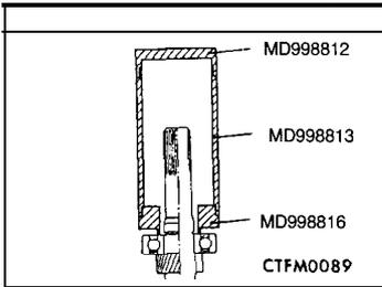
▶◀ J ◀ FRONT BALL BEARING / FRONT TAPER ROLLER BEARING INSTALLATION
