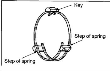
**►I◄ OD-R SYNCHRONIZER KEY/OD-R SYNCHRONIZER SPRING INSTALLATION**
