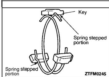
►C◄ **SYNCHRONIZER SPRING INSTALLATION**
