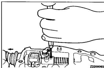
►◄ SPRING PIN / LOCK PIN INSTALLATION
