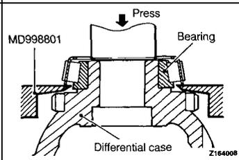
◀B▶ TAPER ROLLER BEARING REMOVAL
