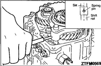
►◀ **SPRING PIN FOR OD-R SHIFT FORK INSTALLATION**
