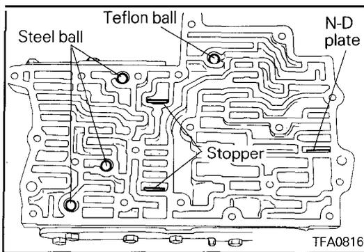
**▶A▶ STOPPER PLATE / N-D PLATE / TEFLON BALL / STEEL BALL LOCATION**
