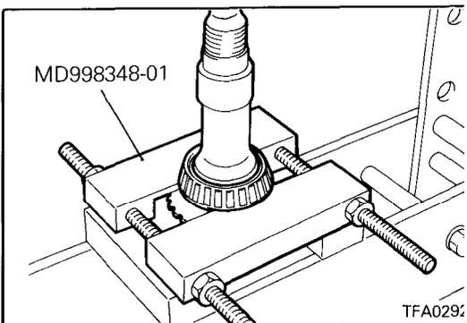
**◁D▷ TAPER ROLLER BEARING REMOVAL**
