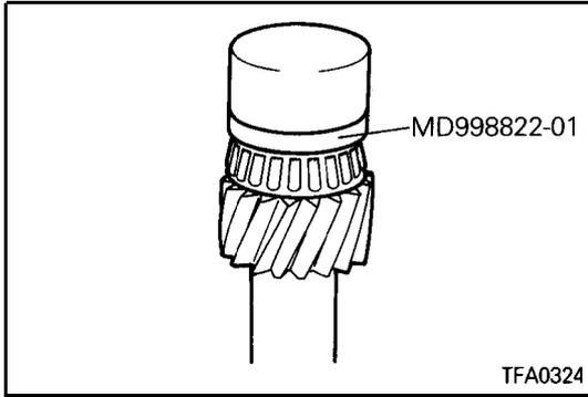
⇨B⇩ TAPER ROLLER BEARING INSTALLATION
