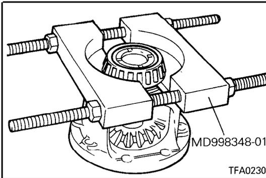
◁B▷ TAPER ROLLER BEARING REMOVAL
