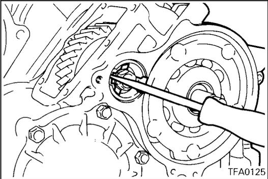
27. Disengage the bolt stopper and remove the bolt.
