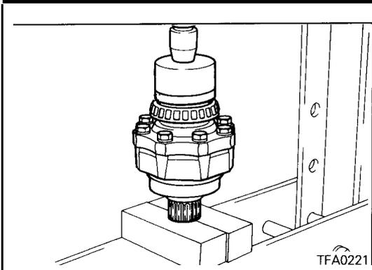
**◆C◆ TAPER ROLLER BEARING INSTALLATION**
