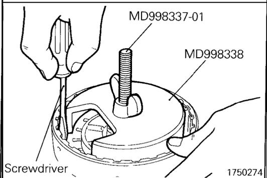
**REASSEMBLY SERVICE POINTS****▶A▶ WAVE SPRING INSTALLATION**
