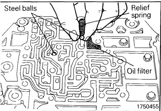
**▶C▶ OIL FILTER / STEEL BALL / RELIEF SPRING INSTALLATION**
