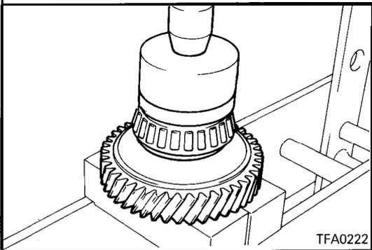
**◆D◆ TAPER ROLLER BEARING INSTALLATION**
