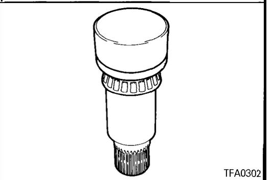
◆B◆ DRIVE BEVEL GEAR INSTALLATION
